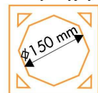
Pustak do przewodów dymowych i wentylacyjnych typ P (PN-73/B-12007)
